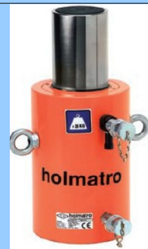
Überdruckventil verhindert gefährliche Situationen bei falsch angeschlossenen Zylindern
