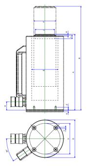
Leistung : 50 -100 Tonnen Hub : 50 - 250 mm maximaler Betriebsdruck : 700 bar
