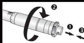
Einfaches Entriegeln und Einstellen des gewünschten Drehmomentwertes durch Drehen des Griffs.
