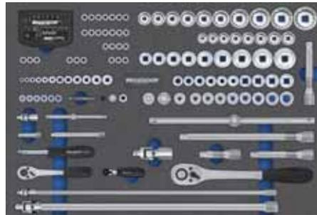
Torsions-Bitbox, Bitknarre, Steckschlüssel-Einsätze in Sechskant und Doppel-Sechskant, u.a. SW 4-34 mm, T6-T40, E4-E24, Adaptersatz, etc.
