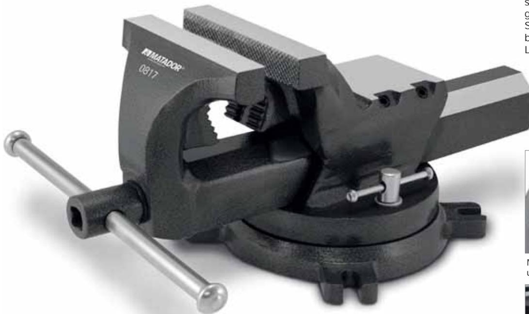
Der Klassiker für jede Werkstatt: Vollständig **aus hochwertigem Stahl** geschmiedeter Parallelschraubstock mit **induktionsgehärteten und geschliffenen Backen** mit gefrästen Zähnen. Großer, **gehärteter Amboss**. Gewalztes, zweigängiges Trapezgewinde für präzise und schnelle Bedienung. **Integrierte Rohrspannbacken**. Gegen Verschmutzung und Beschädigung geschützte Spindellagerung. Spannweite höher als Backenbreite für mehr Komfort. Lieferung mit **360°-Drehsteller**.
