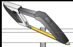
Alternative Blattspannung mit 55° zum bündigen Absägen von Zapfen o.ä.
